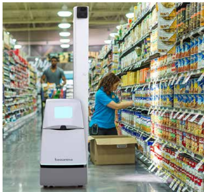
図3 在庫管理ロボット Bossa Nova（出典 Bossa Nova Web サイト）
