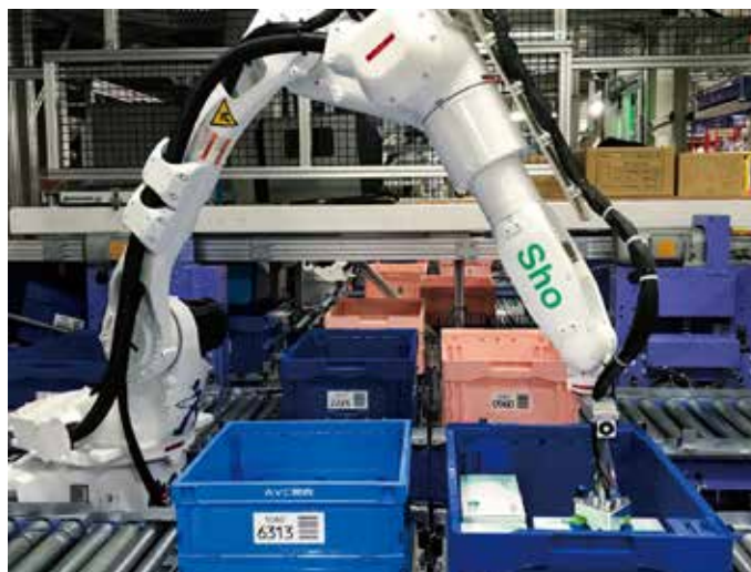
図4 MUJIN 社のピースピッキングロボット（出典 MUJIN Web サイト）
