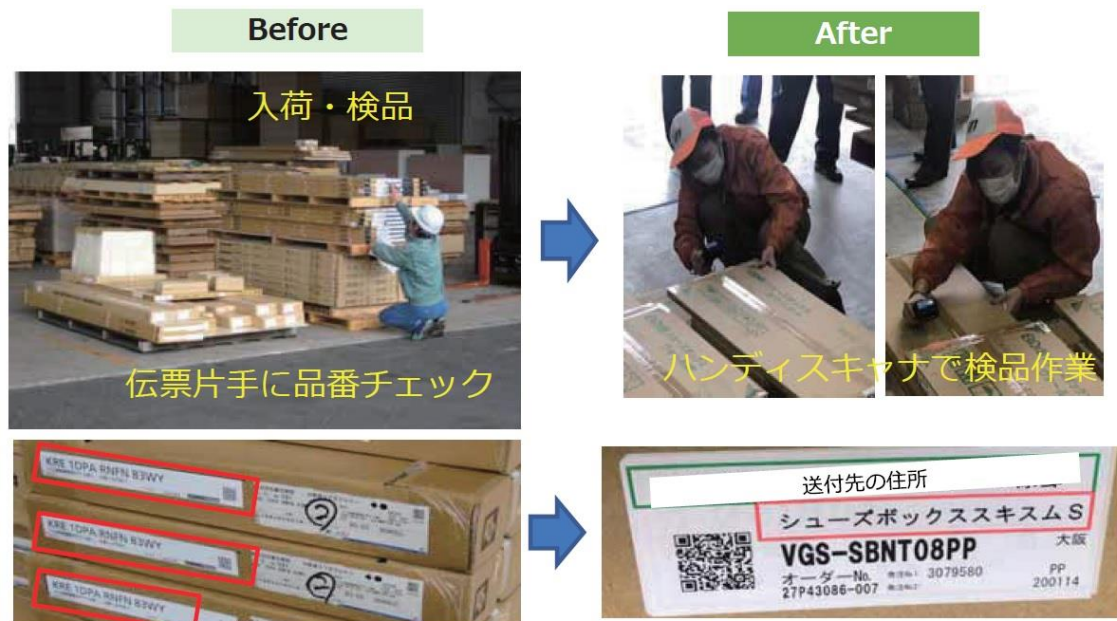
図6. 二次元コード導入前後の検品作業のイメージ
